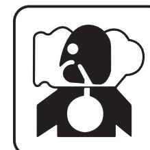
Выхлопные пары двигателя токсичны и могут привести к отравлению. Не запускайте двигатель и не оставляйте его работающим в помещениях в положении, когда выхлопные пары могут попасть в органы дыхания людей и животных.
