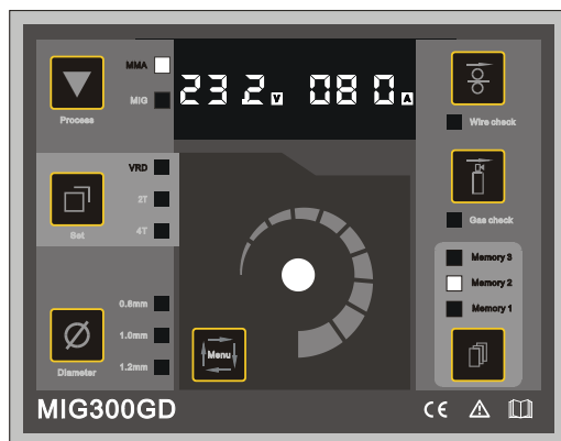
Изображение 4: показатели дисплея при режиме сварки MMA
