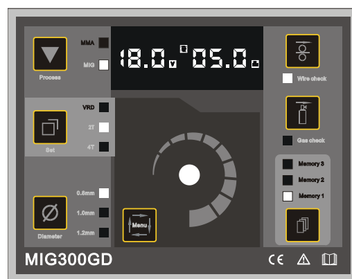
Изображение 6: Дисплей проверки проволоки при MIG сварке
