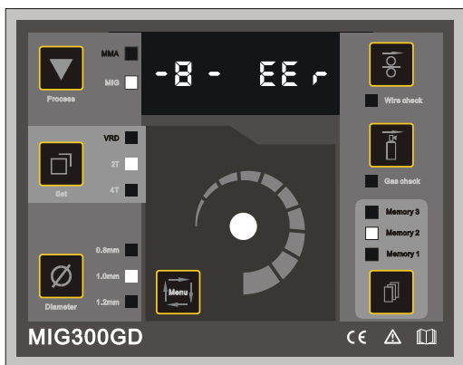
Изображение 12 : неисправный дисплей механизма подачи проволоки
