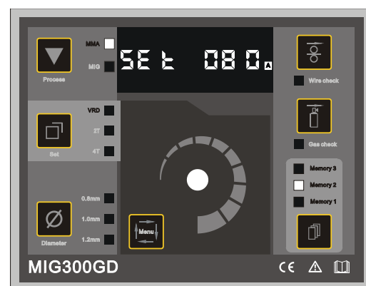
Изображение 3: Режим сварки MMA, заданный ток, дисплей без поддержки VRD
